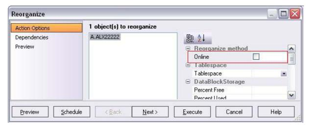
オンライン再編成は DBMS\_REDEFINITION 手続きを使って実装されています。DBMS\_REDEFINITION は、Oracle の オンライン テーブル再編成パッケージであり、Oracle 9i で提供されています。
